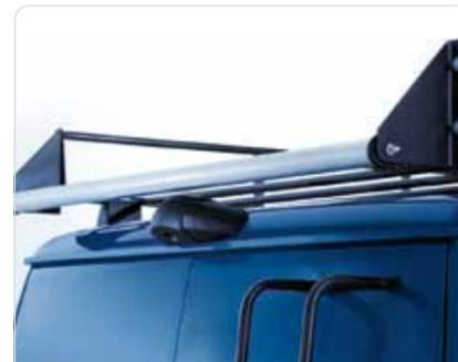
**Ролик для загрузки багажника крыши**
